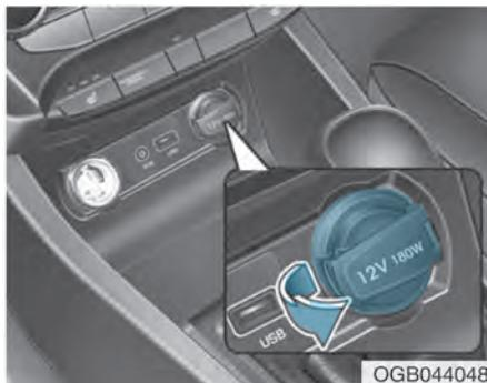
Ovaj priključak dizajniran je kako bi snabdeo energijom mobilne ili druge uređaje dizajnirane kako bi funkcionalisali s električnim sistemom vozila. Uređaji bi trebalo da vuku manje od 180 W dok motor radi.
