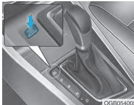
1. Pritisnite taster za shift-lock otpuštanje.
