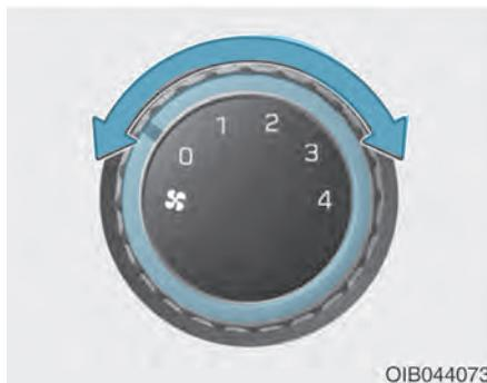
Okrenite taster prema desno da bi povećali brzinu ventilatora i protok vazduha. Okrenite ga prema levo da bi smanjili brzinu ventilatora i protok vazduha.
