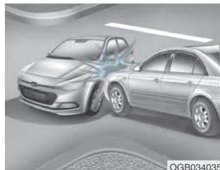
i u drugim sudarima ako bočni senzori sudara detektuju dovoljan udarac. Vazdušni jastuci se mogu aktivirati i ukoliko je karoserija vozila udarana zbog rupa ili objekata na putu. Vozite oprezno na takvim putevima ili na površinama koje nisu namenjene za saobraćaj vozila kako bi sprečili neželjene aktivacije vazdušnog jastuka.
