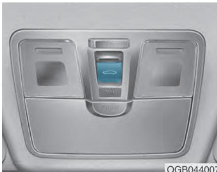
Ako je Vaše vozilo opremljeno krovnim prozorom, možete pomerati ili nagnuti krov s prekidačem za upravljanje krova koji se nalazi na konzoli na plafonu.
