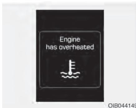
Ova poruka upozorenja svetli kada je temperatura rashladne tečnosti motora iznad 120 °C. To znači da je motor pregrejan i može se oštetiti.
