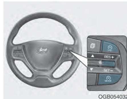
I/O: Uključuje i isključuje sistem tempomata.
