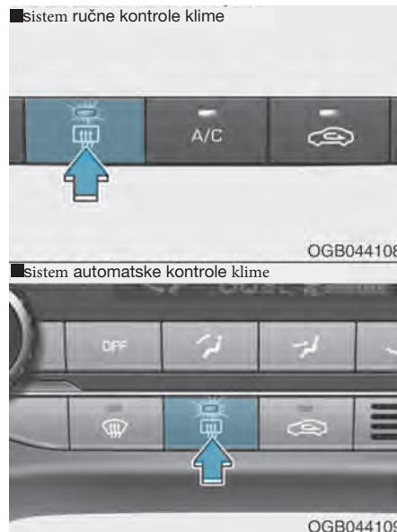
koji se nalazi na sistemu kontrole klime. Indikator zadnjeg uređaja za odleđivanje zasvetli kad je uređaj za odleđivanje uključen.
