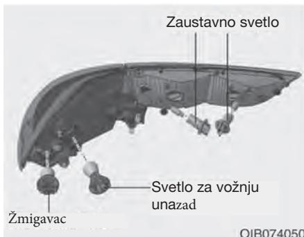
4. Uklonite utičnicu od sklopa okrećući utičnicu suprotno od kazaljke na satu dok se jezičci na utičnici ne poravnaju s ulazima na sklopu.
