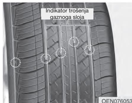
Ako je guma istrošena ravnomerno, indikator istrošenosti pojaviće se na profilu gume u obliku ravnomerne trake. To pokazuje da je ostalo manje od 1,6 mm omotača na gumi. Zamenite gumu kada se to dogodi.
