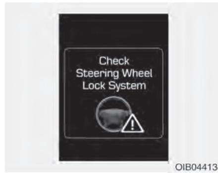
Ova poruka upozorenja svetli ako se volan ne zaključava normalno dok se taster motora Start/Stop pomeri u položaj OFF.
