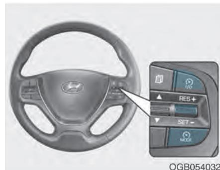
Uključuje i isključuje sistem kontrole ograničenja brzine.
