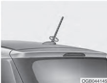
Krovna antena prima AM i FM radio signale. Okrećite krovnu antenu u smeru suprotnom od kazaljki na satu kako biste je uklonili. Okrećite u smeru kazaljke na satu kako biste je ponovo instalirali.
