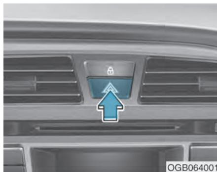
Za uključivanje ili isključivanje četiri žmigavca, pritisnite taster svetla u slučaju nužde s tasterom motora Start / Stop u bilo kom položaju. Taster se nalazi u centru komandne table. Svi žmigavci će treptati istovremeno.
