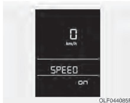
U slučaju tipa A, digitalni brzinomer se prikazuje kada je „SPEED“ podešena na „ON“ na ekranu.
