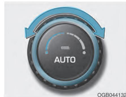
Temperatura će se povećati do maksimuma (HI) okretanjem tastera prema desno.
