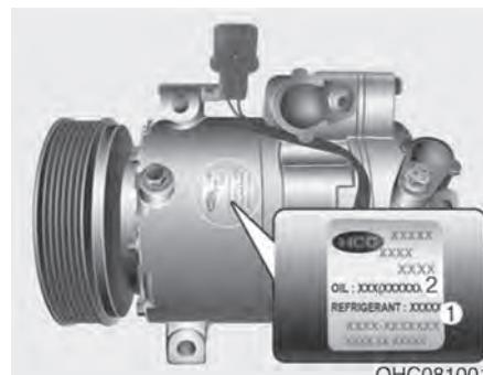
Oznaka kompresora vas obaveštava s kojim tipom kompresora je vaše vozilo opremljeno; model, broj dobavljača, broj proizvodnje, hladnjak (1) i rashladno ulje (2).
