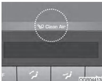
Kada je prekidač za paljenje u položaju ON, funkcija za čist vazduh pali se automatski.
