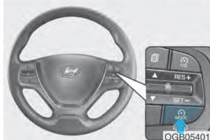
1. Pritisnite taster na volanu, a zatim pritisnite taster za uključivanje sistema. Svetleće indikator ograničenja brzine na instrument tabli.
