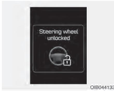
Ova poruka upozorenja svetli ako se volan ne zaključa dok se taster motora Start/Stop pomeri u položaj OFF.
