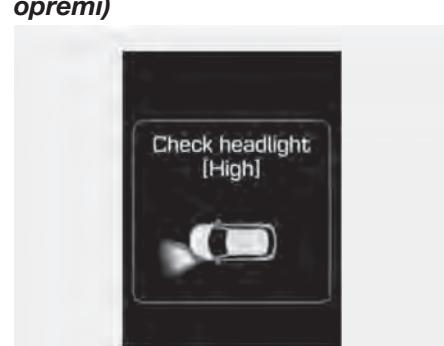
Ova poruka upozorenja svetli ako postoji kvar (pregorela sijalica osim LED sijalice ili kvara u strujnom kolu) na prednjim svetlima (prednja svetla, svetla kočnice, svetla za maglu, itd.). U tom slučaju, neka Vaše vozilo pregledaju kod ovlašćenog HYUNDAI zastupnika.
