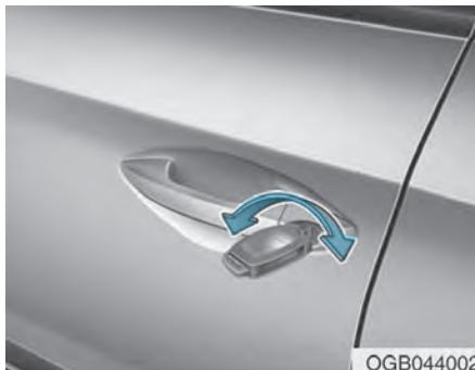
Okrenite ključ prema zadnjem delu vozila za otključavanje i prema prednjem delu vozila za zaključavanje.
