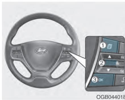
Putni računar je mikrokompjuterski kontrolisani informacioni sistem za vozača koji prikazuje informacije vezane uz vožnju kada je prekidač za paljenje u položaju ON. Sve sačuvane informacije o vožnji (osim brojača kilometara) se resetuju ako je akumulator odspojen.
