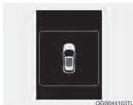
Ovo upozorenje svetli ako isključite motor dok je krovni prozor otvoren.
