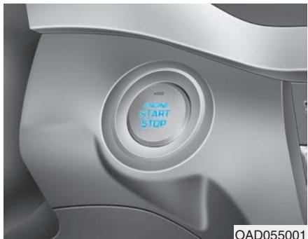
Kad god su prednja vrata otvorena, taster Start / Stop će svetleti i ugasiće se 30 sekundi nakon zatvaranja vrata. (ako je u opremljenosti)
