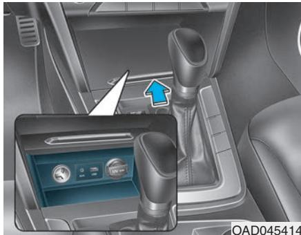
Da biste otvorili kasetu, pritisnite poklopac i polako će se otvoriti. Da biste zatvorili poklopac, pritisnite ga i lagano zatvorite.
