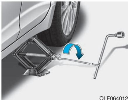
8. Umetnите ručicu dizalice u dizalicu i okrenite suprotno od smera kazaljke na satu podižući vozilo dok se guma ne odvoji od tla. Proverite da li je vozilo stabilno na dizalici.
