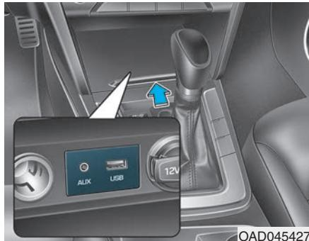
Možete koristiti AUX priključak za spajanje audio uređaja i USB port priključak za spajanje na USB i iPod® ulaz.
