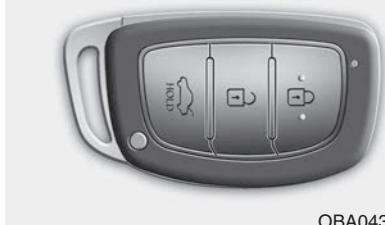
Za zaključavanje vrata, pritisnite dugme na spoljnoj ručici noseći pametni ključ sa sobom ili pritisnite taster za zaključavanje vrata na pametnom ključu.
