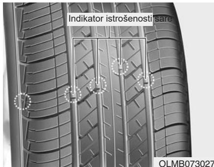
Ako je guma istrošena ravnomerno, indikator istrošenosti pojaviće se na profilu gume u obliku ravnomerne trake. To pokazuje da je ostalo manje od 1,6 mm omotača na gumi. Zamenite gumu kada se to dogodi. Nemojte čekati da se traka pojavi na celom gazištu pre zamene guma.
