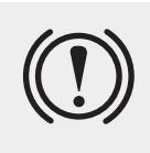
Proverite lampicu upozorenja parkirne kočnice stavljanjem kontakt brave u položaj ON (ne pokrećite motor).
