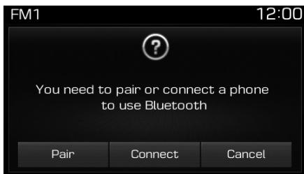
Ako su Bluetooth® uređaji upareni, samo nisu trenutno konektovani, pritiskom na taster [PHONE] ili taster [CALL] na kontrolama na volanu, prikazaće se sledeći ekran. Pritisnite taster [Pair] za uparivanje novog uređaja ili pritisnite tastre [Connect] za konektovanje prethodno uparenog uređaja.
