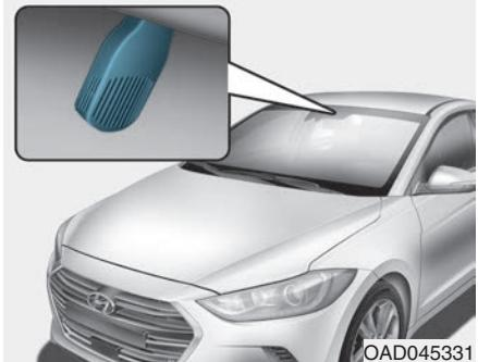
Automatsko odmagljivanje smanjuje mogućnost od zamagljivanja unutrašnjosti vetrobranskog stakla, tako što automatski detektuje vlagu s unutrašnje strane vetrobrana.
