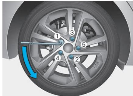
6. Umetnute ključ za matice u otvor poklopca točka i nežno uklonite poklopac točka (ako je u opremi). Otpustite matice točka suprotno od kazaljke na satu jedan okret prema redosledu prikazanom gore, ali ne uklanjajte sve matice dok guma nije podignuta sasvim od zemlje.
