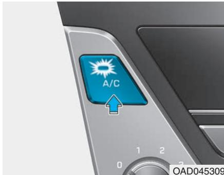
Pritisnite taster A/C kako biste uključili sistem za klimatizaciju (zasvetleće lampica). Ponovo pritisnite taster kako biste isključili sistem za ventilaciju.
