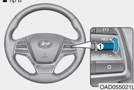
Gurnite dvopolozajni prekidač (1) gore (RES+). Ako je brzina vozila preko 30 km/h (20 mph) vozilo će nastaviti da se kreće podešenom brzinom.
