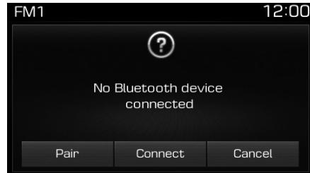
Ako su Bluetooth® uređaji upareni, samo nisu trenutno konektovani, pritiskom na taster [PHONE] ili taster [CALL] na kontrolama na volanu, prikazaće se sledeći ekran. Pritisnite taster [Pair] za uparivanje novog uređaja ili pritisnite tastre [Connect] za konektovanje prethodno uparenog uređaja.
