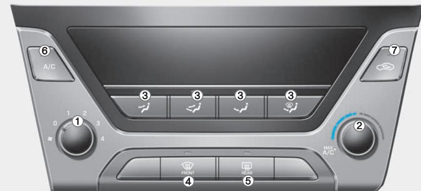
1. Prekidač za kontrolu brzine ventilatora
