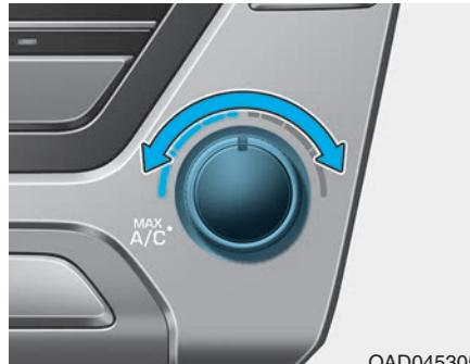
Prekidač za kontrolu dozvoljava da temperaturu izduvanog vazduha iz ventilacionog sistema. Da biste promenili temperaturu vazduha u putničkom odeljku, okrenite prekidač u desnu poziciju za grejanje i topao vazduh, ili u položaj levo za hladan vazduh.
