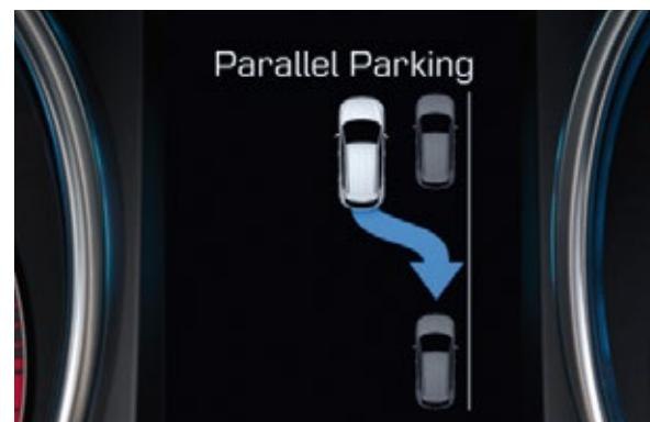
**SISTEM ZA POMOĆ PRI PARKIRANJU (SPAS)** sam će pronaći odgovarajući prostor za paralelno parkiranje i savršeno parkirati ili isparkirati vozilo. SPAS takođe omogućava parkiranje i isparkiravanje vozila pod pravim uglom. Vi kontrolišete komande gasa i kočnice, a sistem radi sve ostalo.
