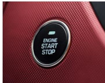
**Prekidač motora Start/Stop.** Možete bez ključa pokrenuti motor pritiskom na prekidač kad god je pametan ključ sa vama u vozilu, na primer u vašem džepu ili vašoj torbi.
