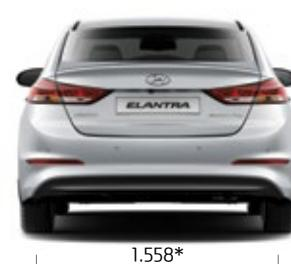
\* Razmak između točkova na istoj osovini • 15" ALU naplatci (napred/nazad) : 1.563/1.572 • 16" ALU naplatci (napred/nazad) : 1.555/1.564 • 17" ALU naplatci (napred/nazad) : 1.549/1.558
